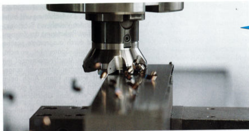
Große Schnitttiefen und eine hohe Oberflächenqualität zeichnen den Double Quattromill 14™ aus. © Seco Tools
